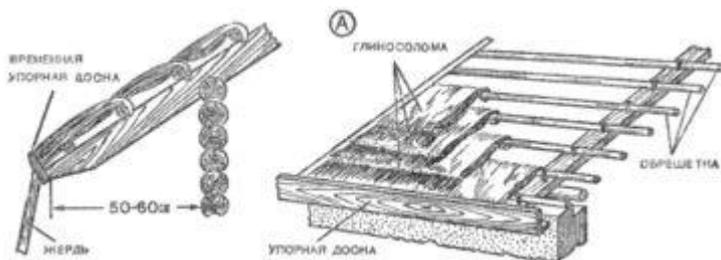
Выложив три-четыре ряда, солому расчесывают металлическими граблями и заливают сверху глиняным раствором. Затем раствор пристукивают и приглаживают лопатой до тех пор, пока кровля не станет ровной. Если работа ведется с перерывами, то края уже уложенных снопиков обычно высыхают. Поэтому перед укладкой нового слоя их рекомендуется смочить глиняным раствором.
